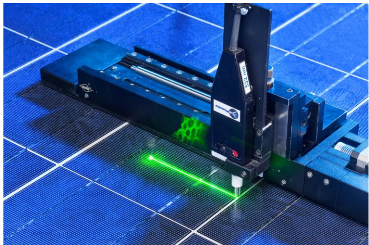
Ramanspektroskopische Messung eines PV-Moduls am Fraunhofer ISE. ©Fraunhofer ISE
