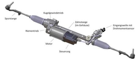
Elektromagnetisches Lenkgetriebe 1er/3er BMW
