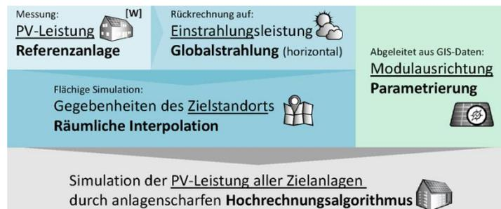
Ablaufschema des vom Fraunhofer ISE und TransnetBW entwickelten Hochrechnungsverfahrens mit Projektion der PV-Leistung von Referenzanlagen auf beliebige Zielanlagen unter Berücksichtigung der Modulausrichtung und einer räumlichen Interpolation. ©Fraunhofer ISE
