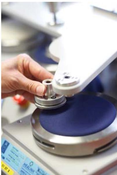
Bei der **Scheuerprüfung** nach der Martindale-Methode wird mit einem Wollstandardgewebe über das Testgewebe gescheuert bis mindestens 2 Fasern des Materials zerstört sind. Dabei werden die benötigten Zyklen ermittelt. Mit dieser Prüfung versucht man Reibung während des Tragens der Kleidung zu simulieren. Die Anzahl der Scheuertouren liegt bei Arbeits- bzw. Schutzkleidung deutlich höher als bei einer Anzugshose.
