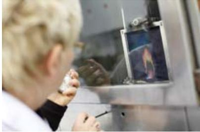
Bei der **Prüfung zum Flammenschutz** wird die Feuerwehrkleidung (EN 469) und Schutzkleidung gegen Hitze und Flamme (ISO 11612) 10 Sekunden mit einem Bunsenbrenner beflammt – danach darf die Probe maximal 2 Sekunden weiter brennen bzw. weiter glühen. Die Beflammung wird im Neu- und im behandelten Zustand an den Flächen und optional an den Kanten durchgeführt.
