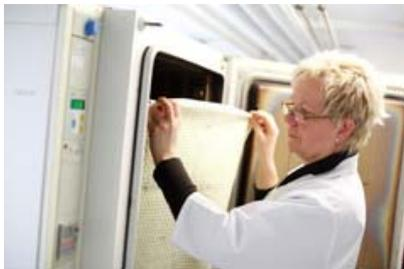
Der **Hitzeschutz** von Textilien wird in einem Wärmeschrank getestet. Bei dieser Prüfung wird die Veränderung der Textilien bei Temperaturen von 180°C bzw. 270°C gemessen. Dafür wird vor der Prüfung eine Messstrecke auf dem Textil aufgebracht, mit der sich das Schrumpfungsverhalten des Materials unter Einfluss von Hitze beurteilen lässt.
