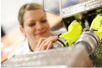
Bei der Ermittlung der **Knickbeständigkeit** werden besonders beanspruchte Stellen wie der Ellenbogen- oder Kniebereich imitiert. Das Material wird dazu im Prüfgerät 9000mal geknickt, gedreht und gestaucht. Auch nach diesem Zyklus dürfen die produktspezifischen Funktionen wie z.B. Wasserdichtigkeit nicht verloren gehen.
