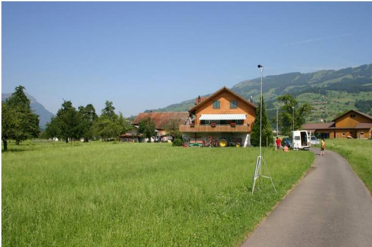
Um das Lärmmodell zu validieren, wurden im Sommer auch Lärmmessungen in grösserer Distanz zur Schienentrasse durchgeführt.
