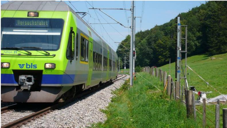
Lärmmessung an einer vorbeifahrenden Zugkomposition; im Vordergrund rechts die Messeinrichtung.
