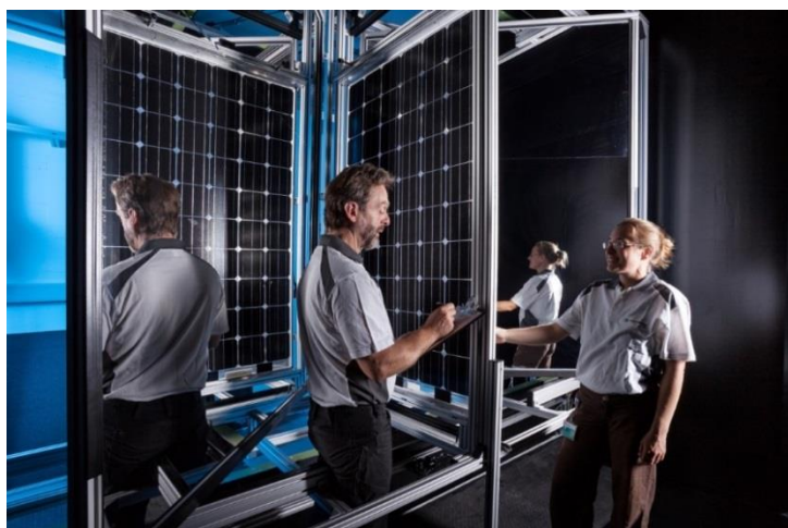
Am Fraunhofer ISE entwickelte Testanordnung für die Vermessung bifacialer Module. ©Fraunhofer ISE
