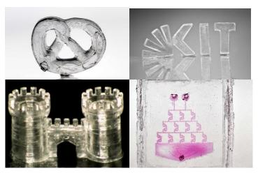
Komplizierte, hochgenaue Strukturen aus Glas lassen sich durch eine am KIT entwickelte Methode im 3D-Druck fertigen. (Fotos: KIT)
