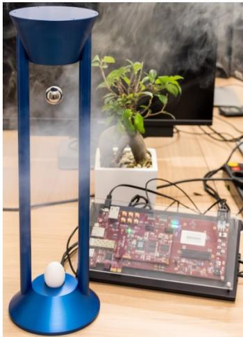
BU: Präzise, kostengünstig und in Echtzeit: Das Single-Chip-Radar mit dem 80 GHz-Sensor des Fraunhofer FHR reguliert Position und Bewegung einer schwebenden Kugel in einem höchst instabilen magnetischen System exakt. © Fraunhofer FHR
