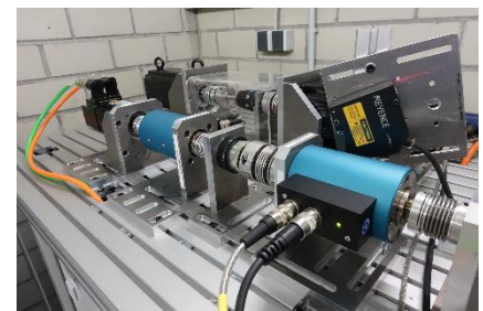
Prüfstand mit skaliert integrierten Prototyp-Bauteilen gemäß des sCiL-Ansatzes. (Foto: IPEK, KIT)
