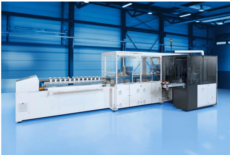
Klebestringer der Firma teamtechnik für die industrielle Verschaltung von Heterojunction-Solarzellen.
