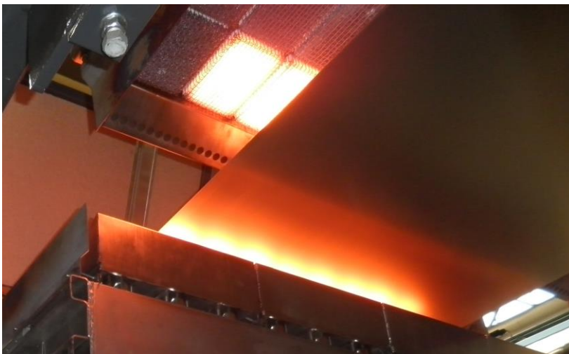
Stahlbandtrocknung nach Vorbehandlung mit Infrarot-Strahlungsporenbrenner (Foto: GoGaS Goch GmbH & Co. KG)
