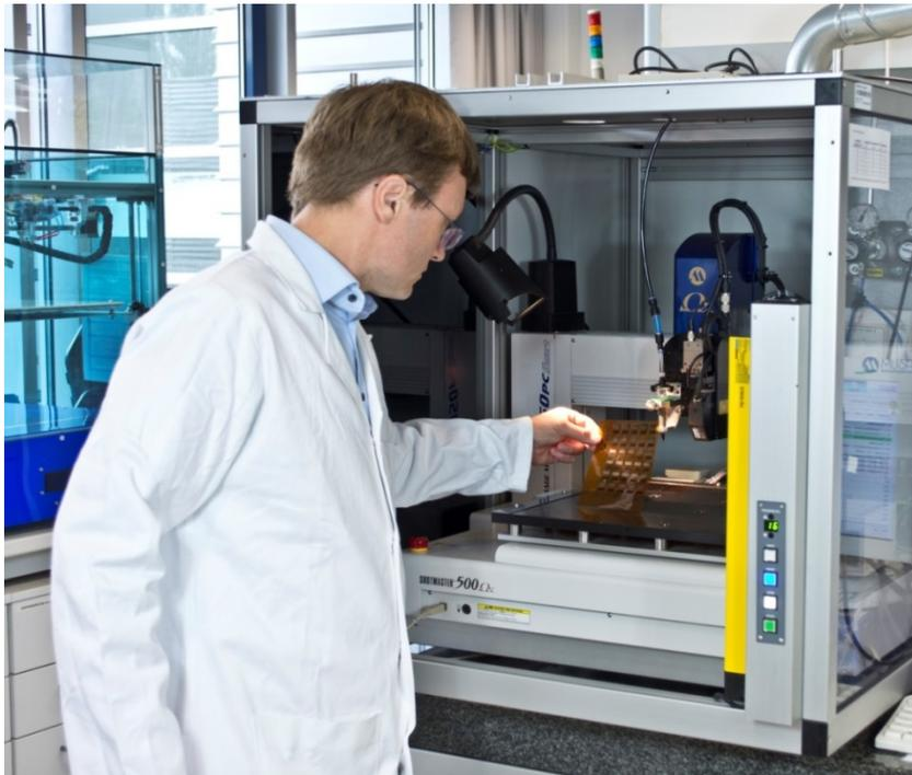
**Dr. Roman Tkachov begutachtet an einem Dispersdrucker im Fraunhofer IWS Dresden eine Folie, die er mit zwei verschiedenen leitenden Polymeren bedruckt hat. »PEDOT:PSS« ist ein Polymer mit positiven Ladungsträgern (»p-leitend«), während »Poly(K<sub>x</sub>[Ni-itto])« negative Ladungsträger transportiert (»n-leitend«). Dies zeigt auch: Die Polymere des IWS lassen sich mit Standard-Techniken wie Druckern oder Rotationsbeschichtung verarbeiten.**
