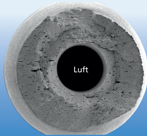
Einfluss von Druckwasserstoff auf das Bruchverhalten und die Duktilität von hohlgebohrten Zugproben.
