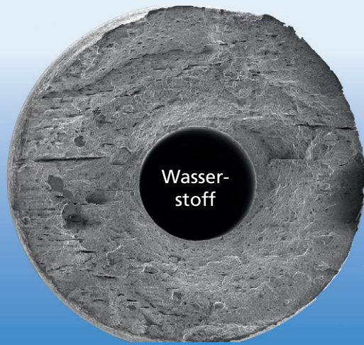
Einfluss von Druckwasserstoff auf das Bruchverhalten und die Duktilität von hohlgebohrten Zugproben.
