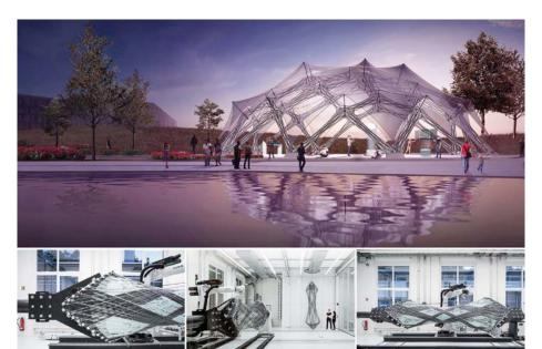
Bild oben: Visualisierung Holzpavillon und Roboterplattform zur Fertigung der tragenden Holzelemente.
