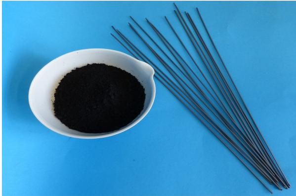
Aus dem Keramikpulver wird mithilfe eines Bindemittels eine Grünkörper-Hohlfaser gesponnen und anschließend gesintert. Die abgebildeten Perowskit-Kapillaren besitzen einen Durchmesser von 2 mm und eine Wandstärke von 150 µm.
