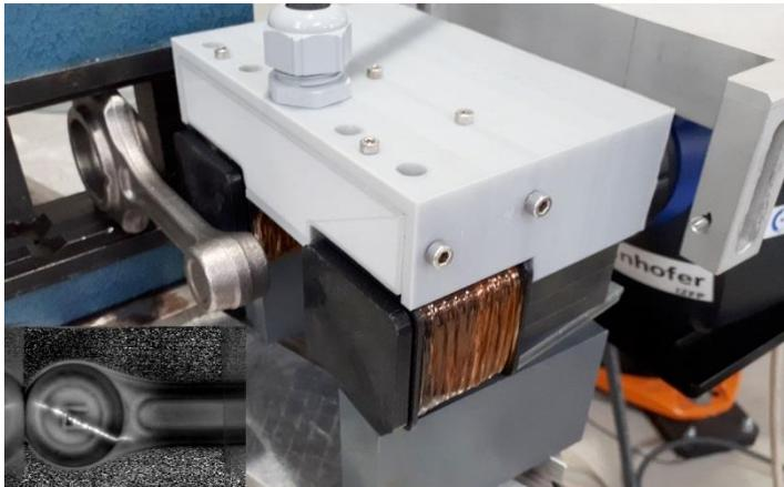
*Messkopf für die automatisierte Erkennung von Oberflächenfehlern in Schmiedeteilen aus Stahl. Unten links: Thermographische Anzeige eines Risses*
