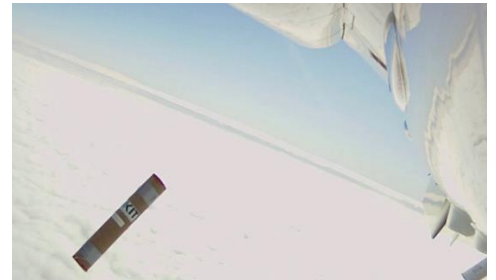
Erstmals kommt auch die neu entwickelte KITsonde zum Einsatz: Einzelne Sensoren werden aus bis zu 13 Kilometer Flughöhe abgeworfen und erfassen dabei Temperatur und Feuchtigkeit der Atmosphäre (Foto: DLR)
