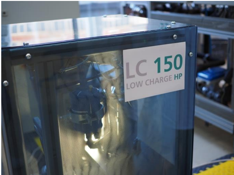
Am Fraunhofer ISE entwickelte leistungsfähige Wärmepumpe mit dem klimafreundlichen Kältemittel Propan für eine Aufstellung innerhalb des Hauses. © Fraunhofer ISE
