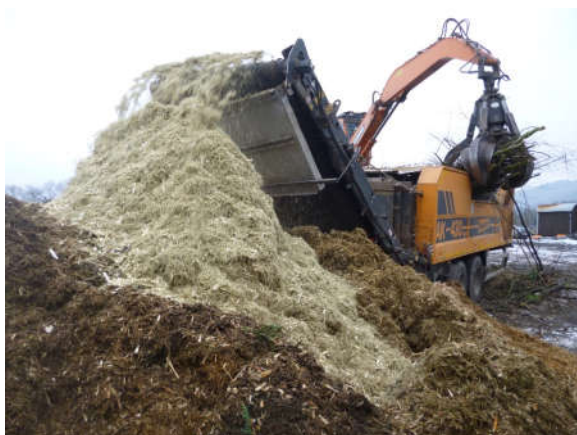
Zerkleinerung von holzigen Grüngut (Quelle: Witzenhausen-Institut)
