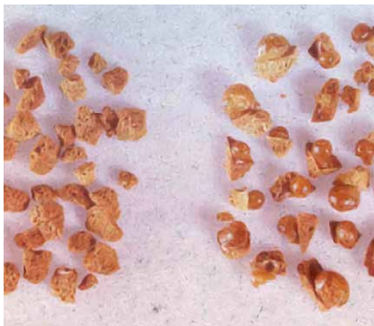
Abb. 9: Aufschmelzen von Produktpartikeln
