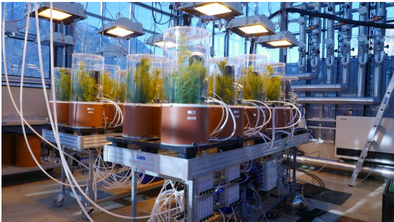
Die Versuchsanordnung: In hochtechnisierten Pflanzenkammern wurden Aleppo-Kiefern steigenden Temperaturen ausgesetzt. (Foto: Plant Ecophysiology Lab, KIT)
