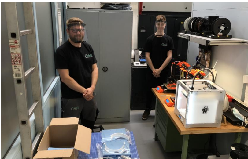
Etwa drei Stunden pro Stück dauert die Produktion eines Visiers per 3-D-Druck. (Foto: wbk, KIT)
