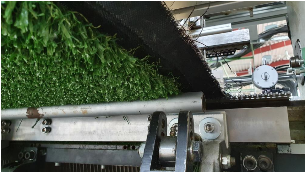
Auslaufbereich der Tuftingmaschine: Der Kunstrasen läuft kopfüber aus der Maschine. Bildquelle: TFI
