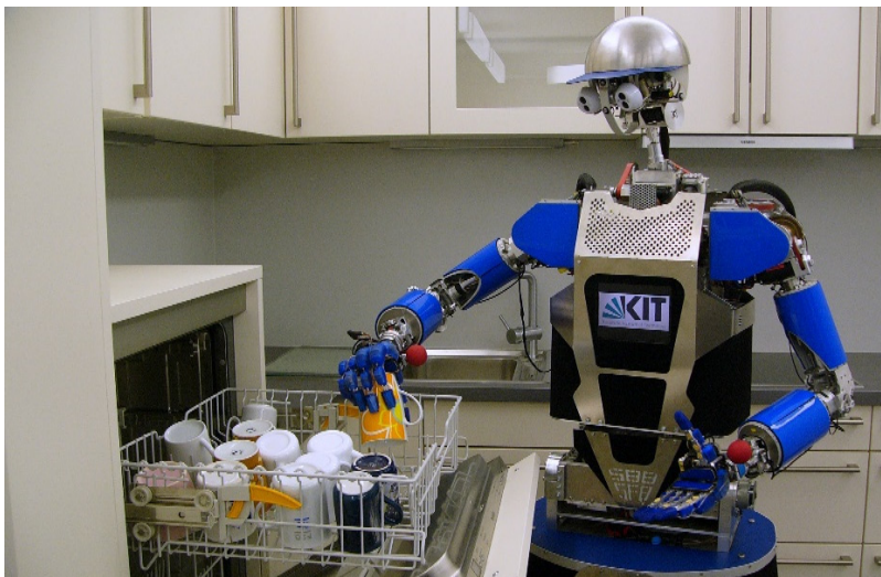
Die humanoiden ARMAR-Roboter – hier ARMAR-III – wurden entwickelt, um Tätigkeiten in Haushalt oder industriellen Umgebungen zu übernehmen. Die nächste Generation wird Senioren im Alltag unterstützen. (Foto: KIT)
