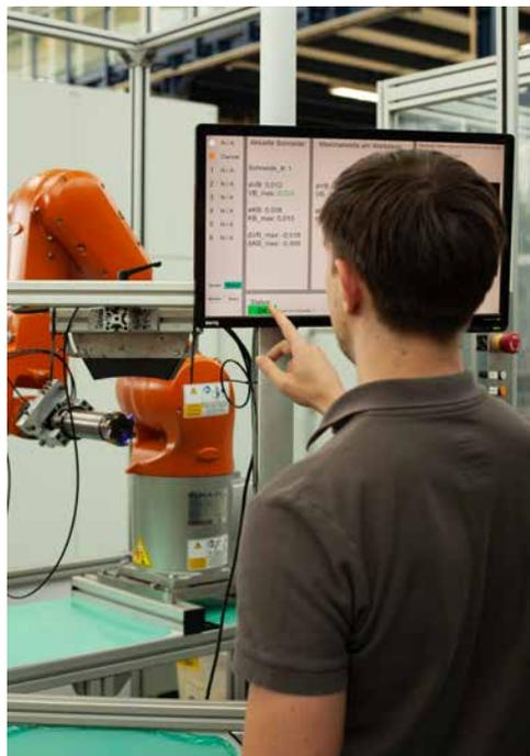
PoWer im Einsatz: Ein Werkzeug wird in das System eingesetzt (links). Nach dem Scan können ermittelte Verschleißdaten am Bildschirm ausgelesen werden (rechts). © Fraunhofer IPK/Andy King
