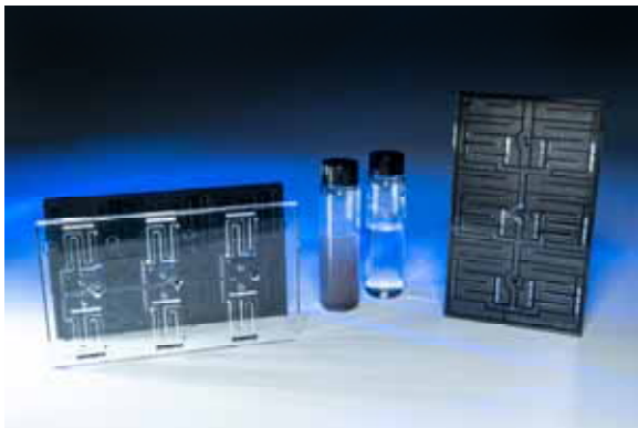
Bild: Mit dem im Projekt MICROCHIP entwickelten mikrofluidischen Lab-on-a-Chip lassen sich Proben aus wenigen Tropfen in kurzer Zeit vollautomatisiert analysieren. (©Fraunhofer IMM)
