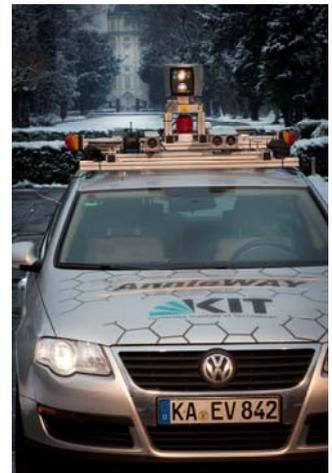
*Kameras und Sensoren auf dem Dach ermöglichen es AnnieWAY sicher, effizient und schnell vorwärts zu kommen. (Bild: KIT)*
