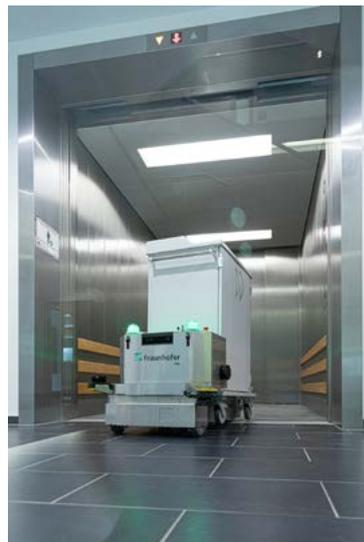
**Wenn der Roboter an die Aufzugsteuerung angebunden wird, kann er sich frei im Haus bewegen.**
