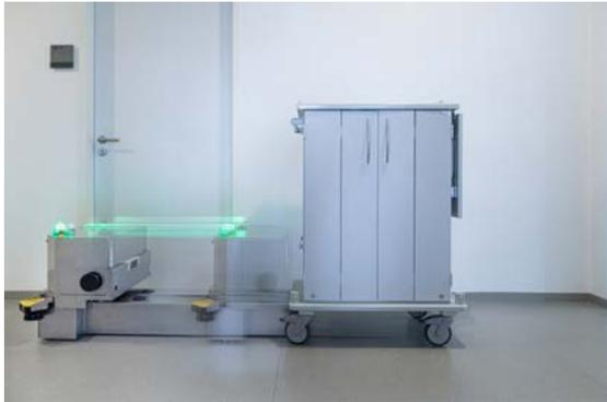
**Der neu entwickelte Transportroboter kann unter diverse Handwagen fahren, diese aufnehmen und zum vorgegebenen Ziel bringen.**
