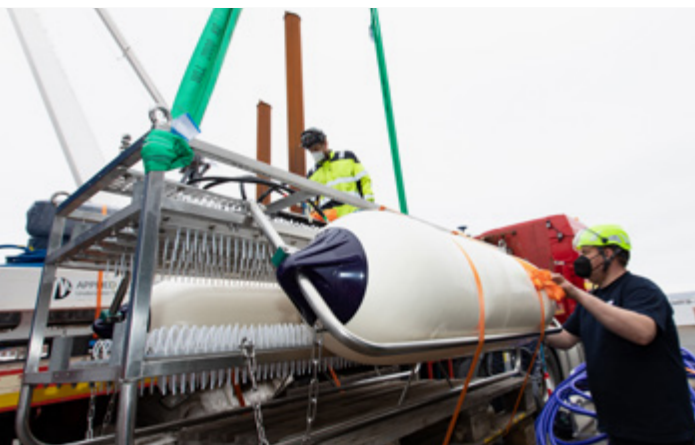
Der „Sparker“ sendet Schallwellen mehrere Hundert Meter in den Meeresboden.
