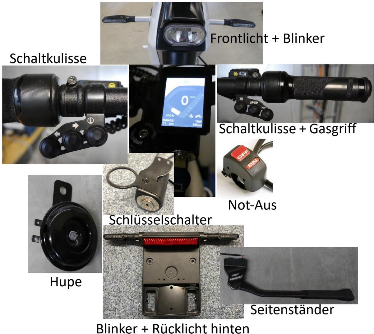
Abbildung 29: verbaute Kleinkomponenten
