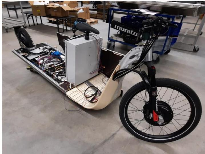
**Abbildung 33: Einbau der Elektronikkomponenten**
