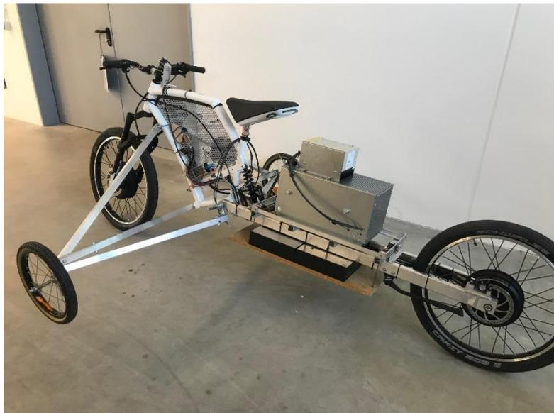
**Abbildung 30: Erster Demonstrator mit Kippsicherung**
