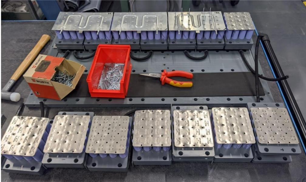
**Abbildung 9: Batteriepack während der Integration der Kühlplatten**
