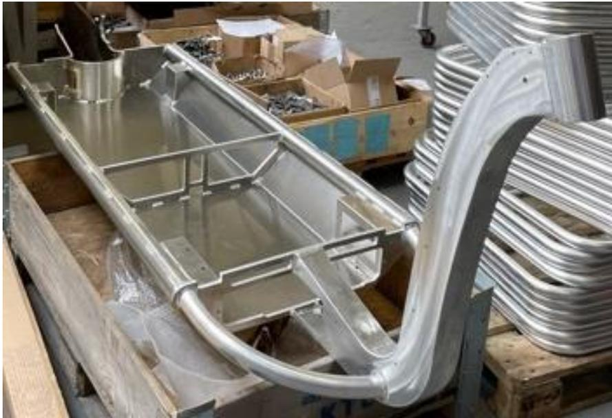
Abbildung 32: Gefertigtes Fahrwerk
