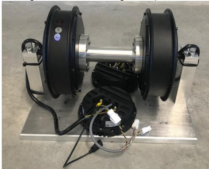
**Abbildung 17: Prüfstand zweier gekoppelter Motoren**
