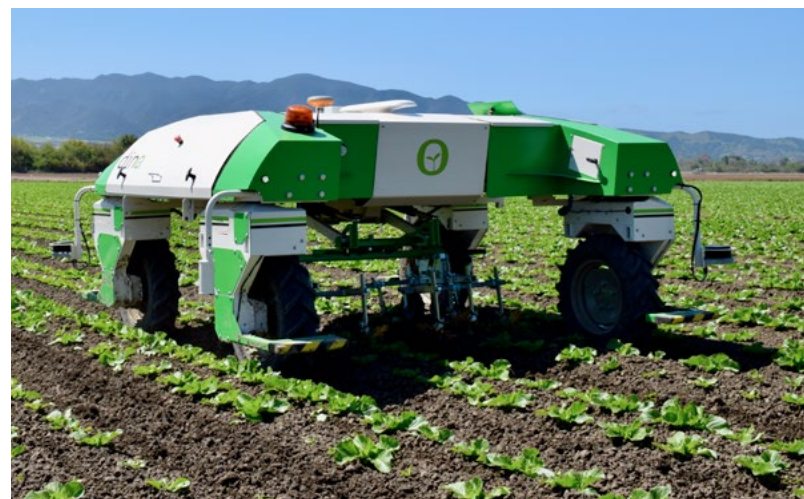
Der Dino war einer der ersten autonomen und elektrischen Roboter auf dem europäischen Markt; er ist seit 2017 kommerziell nutzbar.
