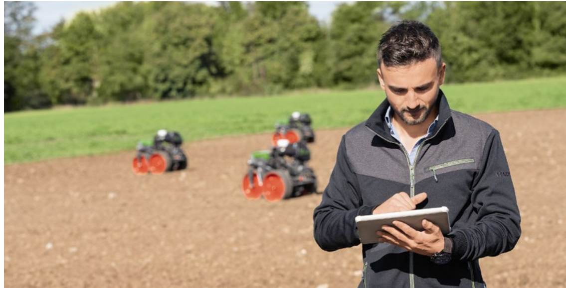
Forschungsprojekt Xaver: Der kleine Feldroboter kann mit mehreren "Artgenossen" gekoppelt werden. Die Lösung ist skalierbar und an die jeweiligen Anforderungen anpassbar.
