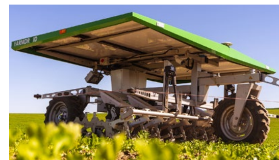
Unterstützt bei der Feldarbeit: Der solarbetriebene Roboter hat sich im Praxistest bewährt.
