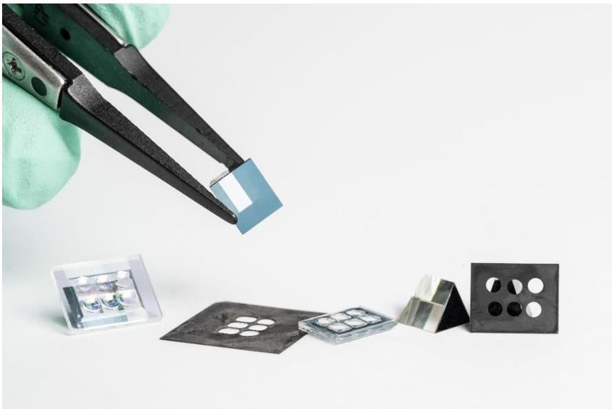
Abb. 1: Gerade einmal 10 mm darf die miniaturisierte Weitwinkel-3D-Kamera groß sein. Hier zerlegt in ihre einzelnen optischen Bauteile. © Fraunhofer IOF
