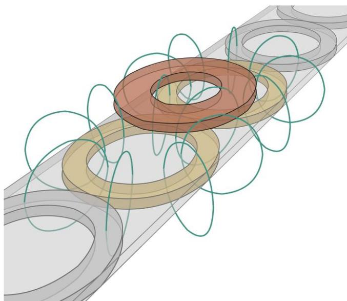
Spulen erzeugen ein elektromagnetisches Feld zur induktiven Energieübertragung.
