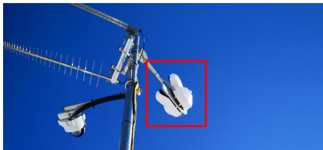
Abbildung 20: Vertikale Einstrahlungssensoren in Ost- und Westausrichtung auf dem Containerdach der Versuchsanlage Davos Totalp.
