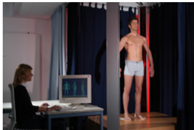
Die Körpermaßstabellen für Jungen und Männer basieren noch auf den Daten aus den 1960er Jahren. Um diese zu aktualisieren, müssten rund 10.000 Probanden aus dem gesamten Bundesgebiet mit dem 3D-Scanner berührungslos vermessen werden.
