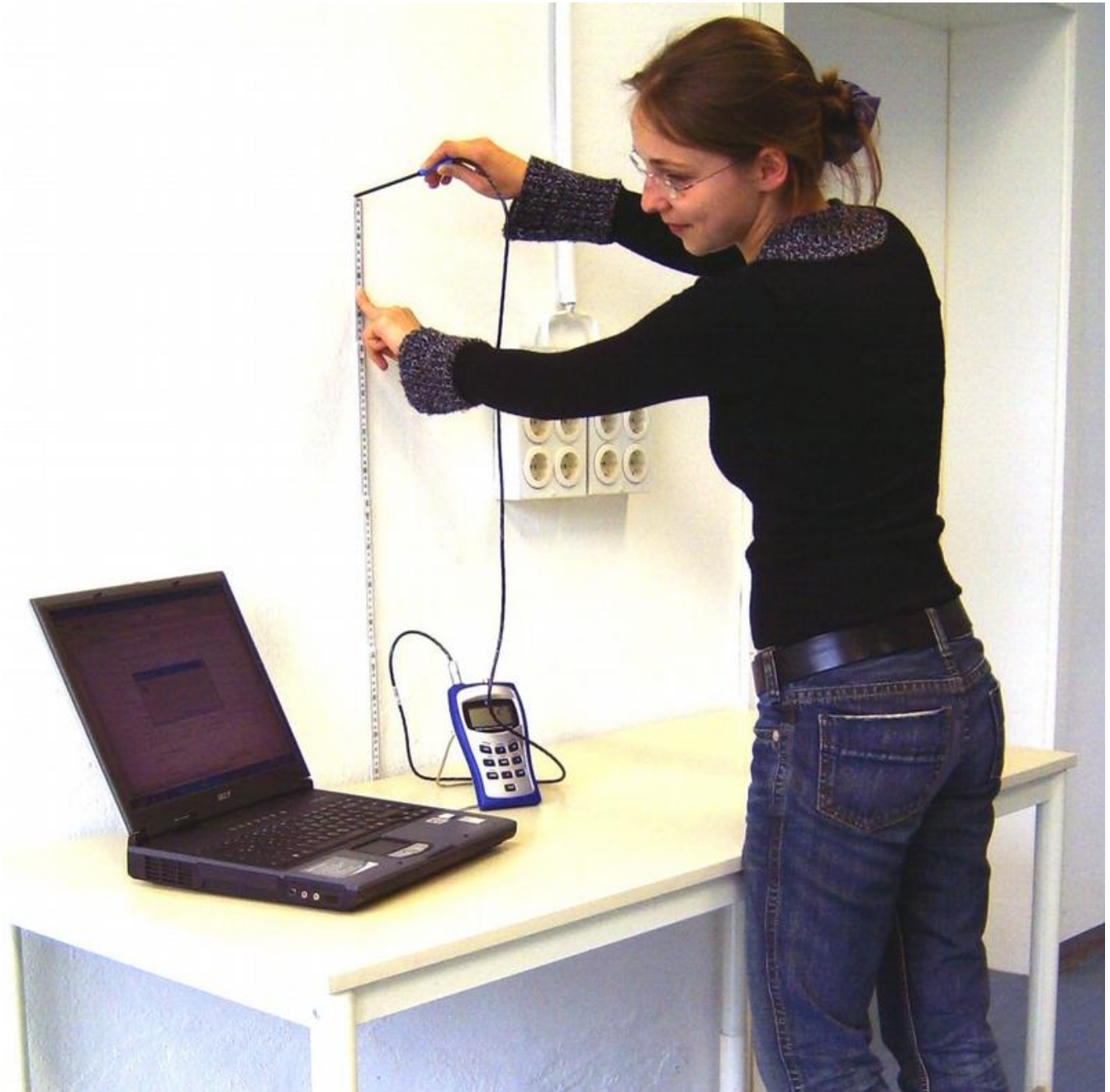
Vermessung der Magnetfelder in der Nähe der Zimmerwand Foto: Projektgruppe
