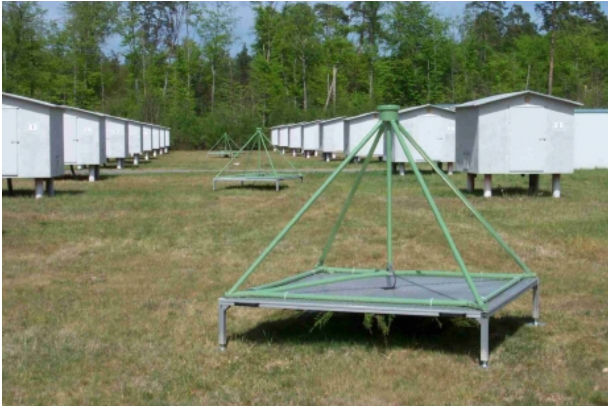
Drei der digitalen LOPES Radioantennen zwischen den Detektorhütten des Luftschauerexperimentes KASCADE-Grande im Forschungszentrum Karlsruhe. Foto: Forschungszentrum Karlsruhe
