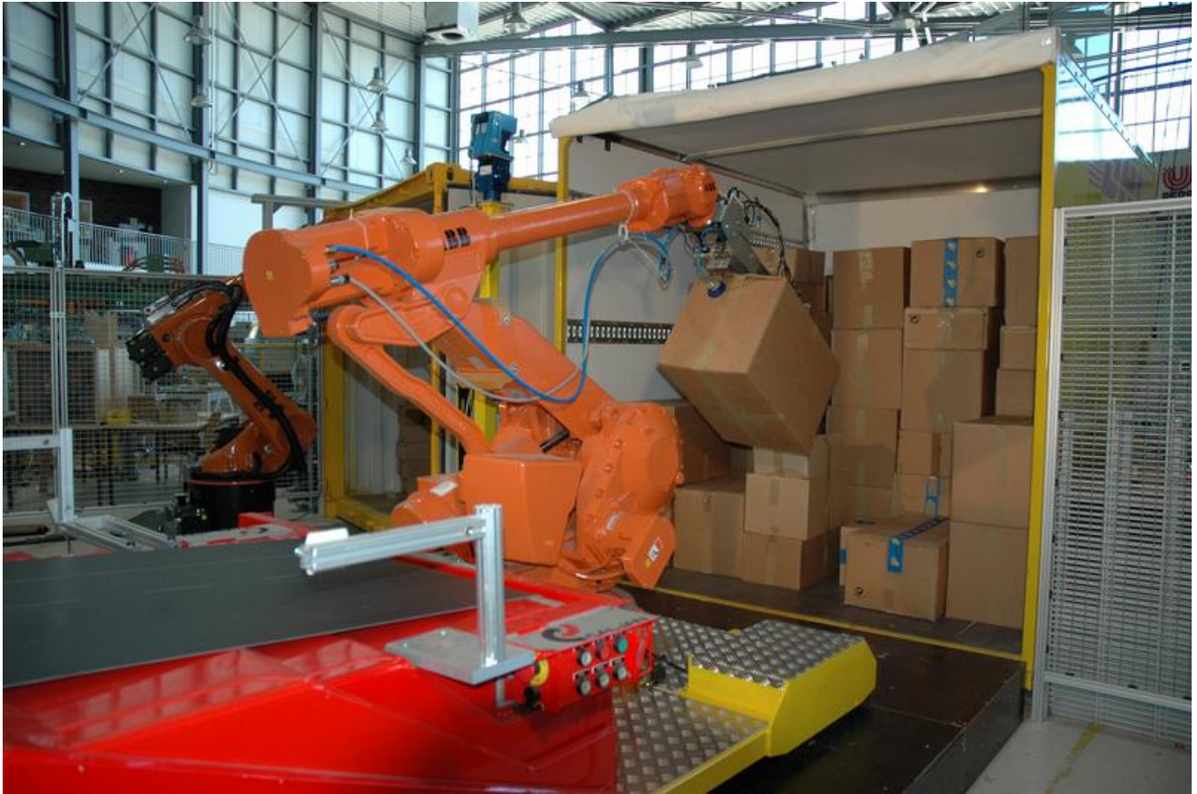
Vollautomatisch entlädt der Paketroboter den Container. Foto: Sabine Nollmann
