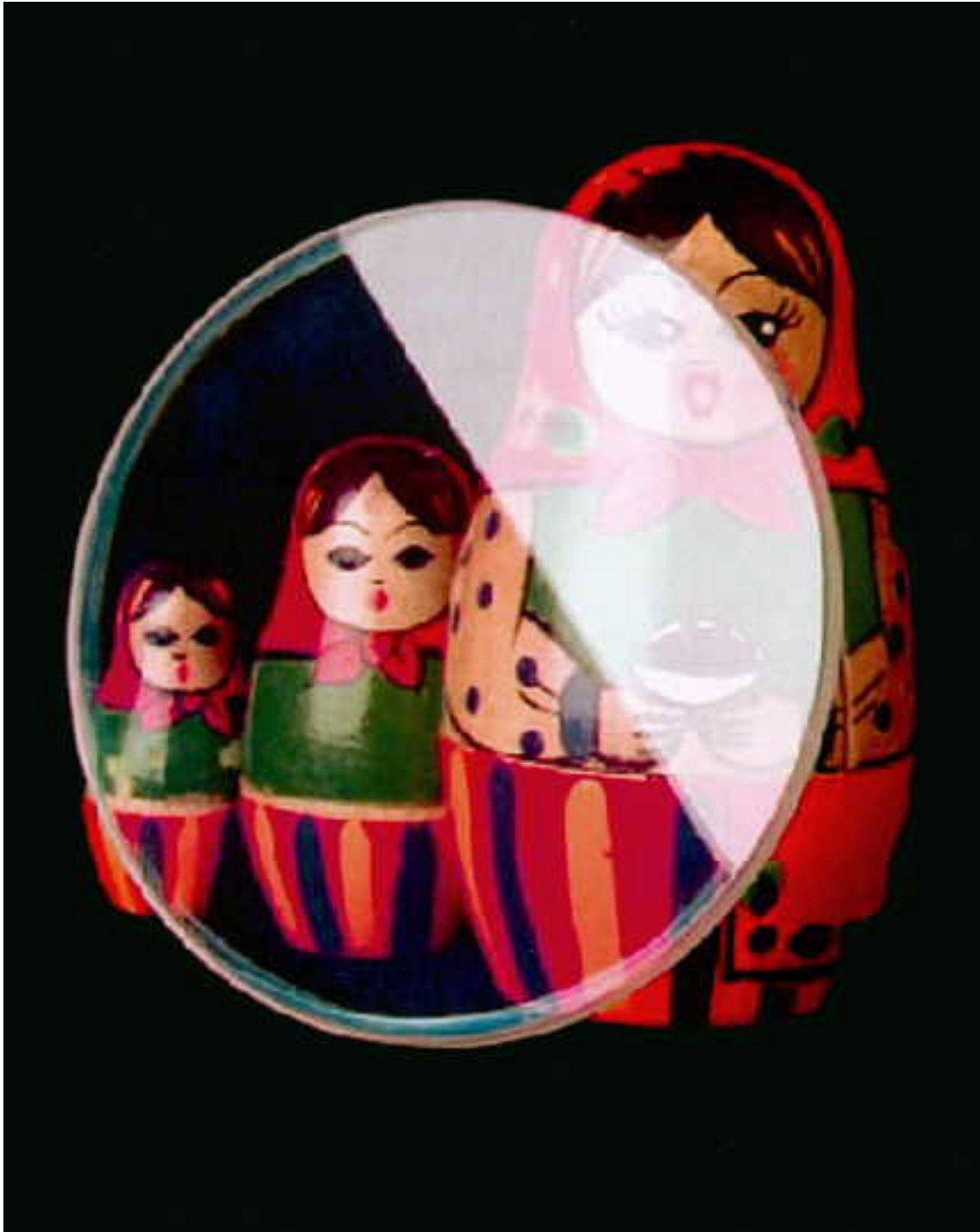
Eine Entwicklung des Forschungszentrums Karlsruhe: Entspiegelung von Glasplatten durch Auftrag eines Nanopolymerfilms. Foto: Forschungszentrum Karlsruhe
