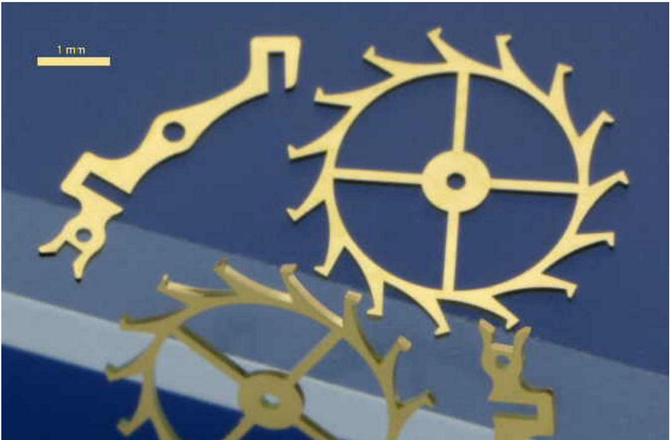
Anker und Ankerrad aus hartem Gold für mechanische Uhrwerke werden im Forschungszentrum Karlsruhe mit dem LIGA-Verfahren so präzise hergestellt, dass keine Schmierung mehr erforderlich ist.
