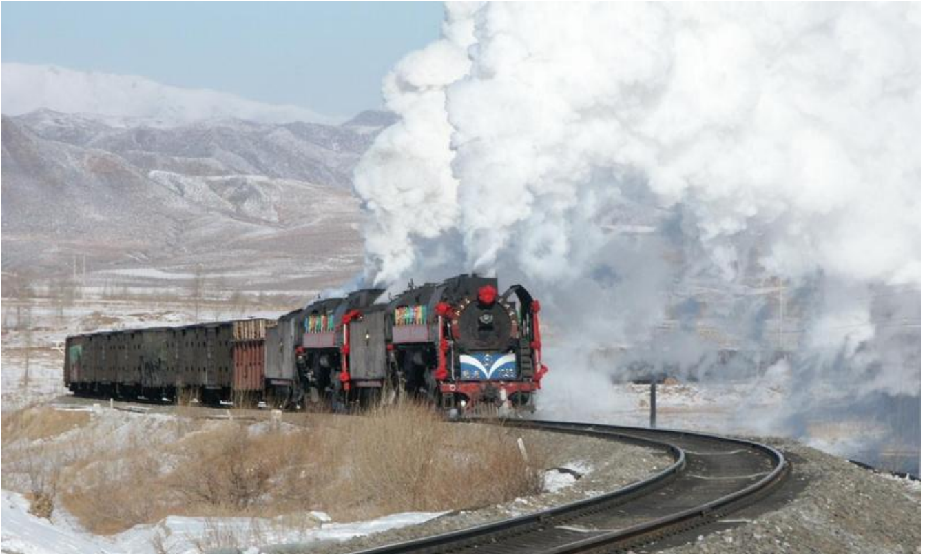
Der letzte Dampflok-bespannte Güterzug auf dem Weg zum Jing Peng-Pass in der Inneren Mongolei gezogen von zwei 2900PS-starken Lokomotiven des Typs QJ FHE, Pfannerstill
