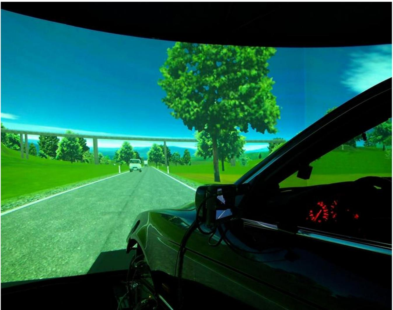
Mit diesem Fahrsimulator untersuchen die Forscher des Würzburger Interdisziplinären Zentrums für Verkehrswissenschaften verschiedenste Fragen. Der Simulator verfügt über ein Bewegungssystem, das Sichtfeld wird in einem 180-Grad-Winkel auf eine sphärische Leinwand projiziert.
