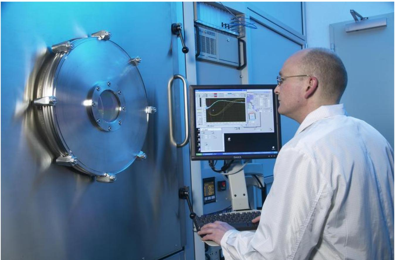
Anlage zur Ionenstrahl-Zerstäubung
