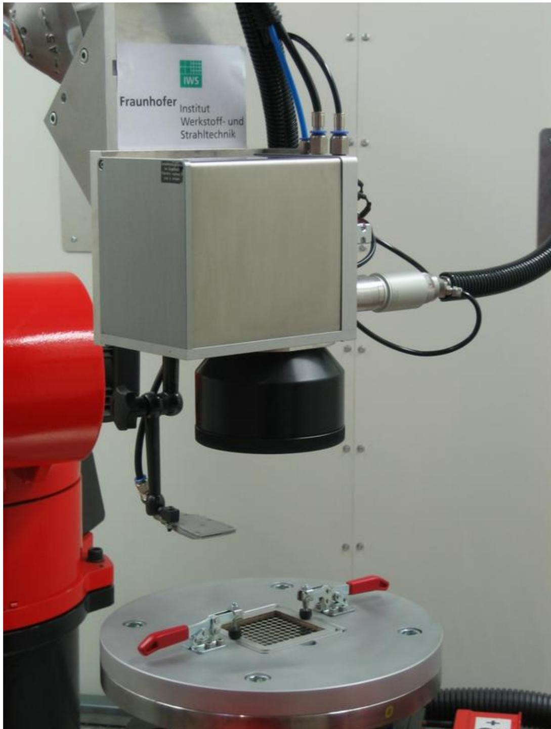
Detail des Laser-Remote-Schneidens von Metallblechen mit Faserlaser
