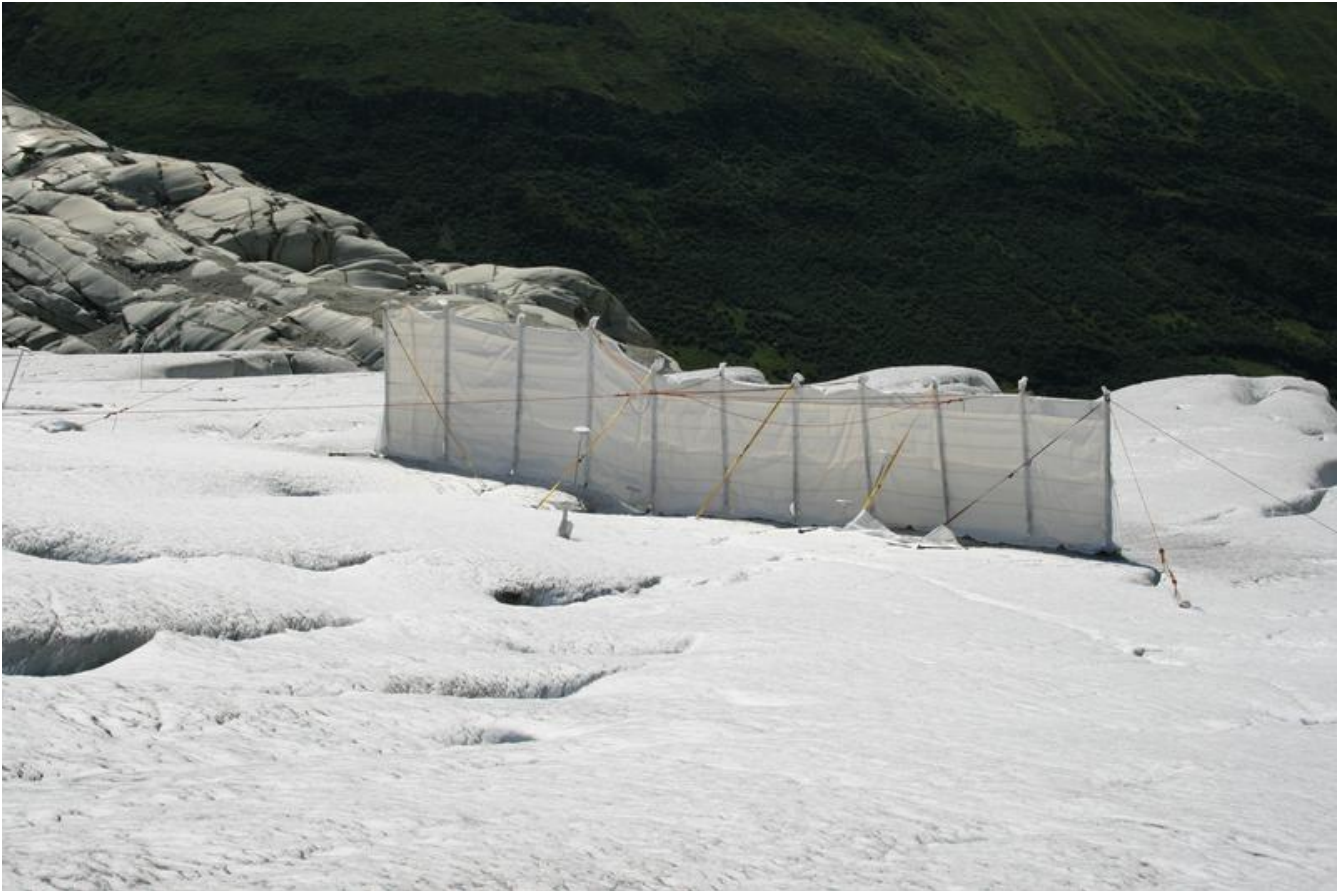
Der Windfang ist mit Stahlstangen im Eis verankert und mit Seilen abgespannt. Geographisches Institut der Universität Mainz
