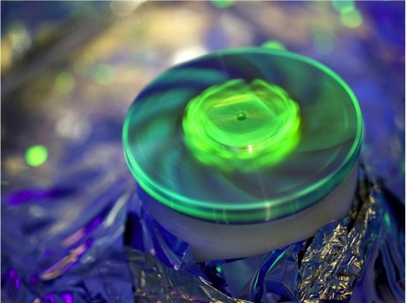
Ein Glassubstrat wird durch Spincoating beschichtet. Bei diesem Vorgang wird das Substrat mit einem für die Farbstoffsolarzelle geeigneten Materialfilm überzogen, der wenige Nanometer dünn ist
