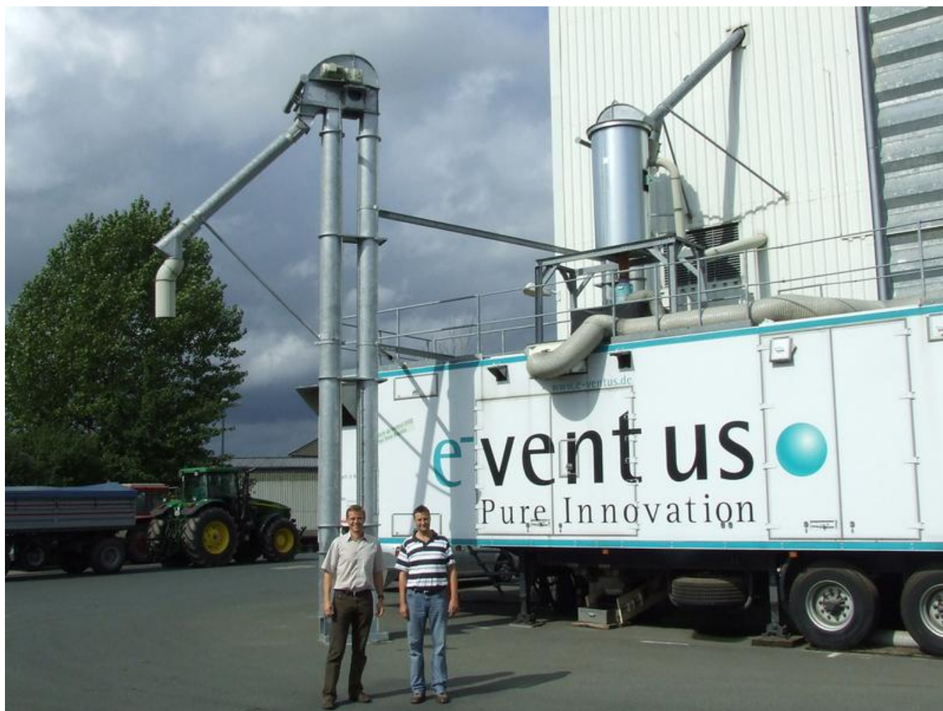
Im e-ventus-Truck reinigen niederenergetische Elektronen Saatgut. © Fraunhofer FEP
