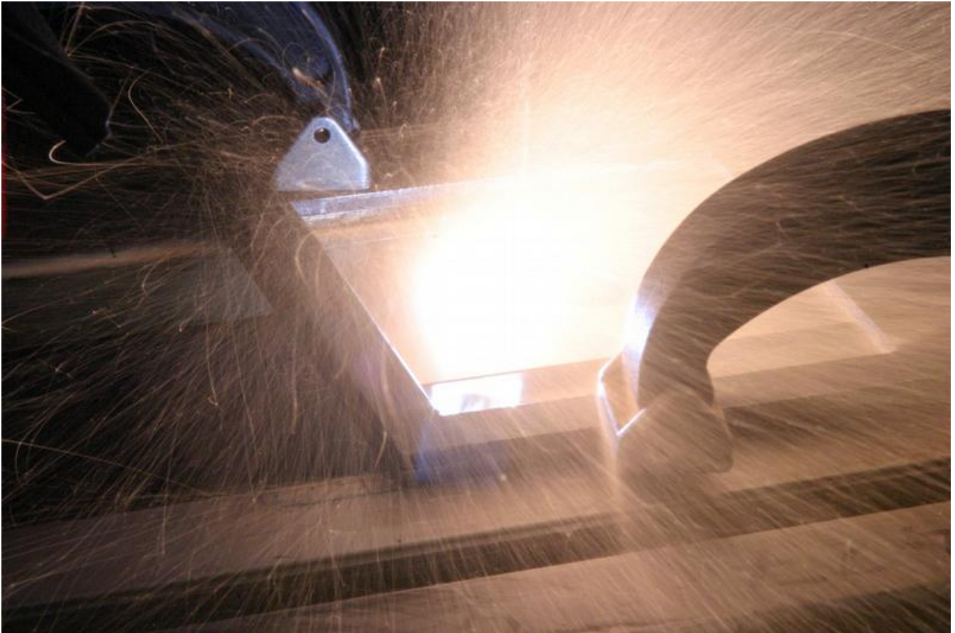
Prozessaufnahme des Remote-Schneidens mit dem Faserlaser Bild: Fraunhofer IWS Dresden
