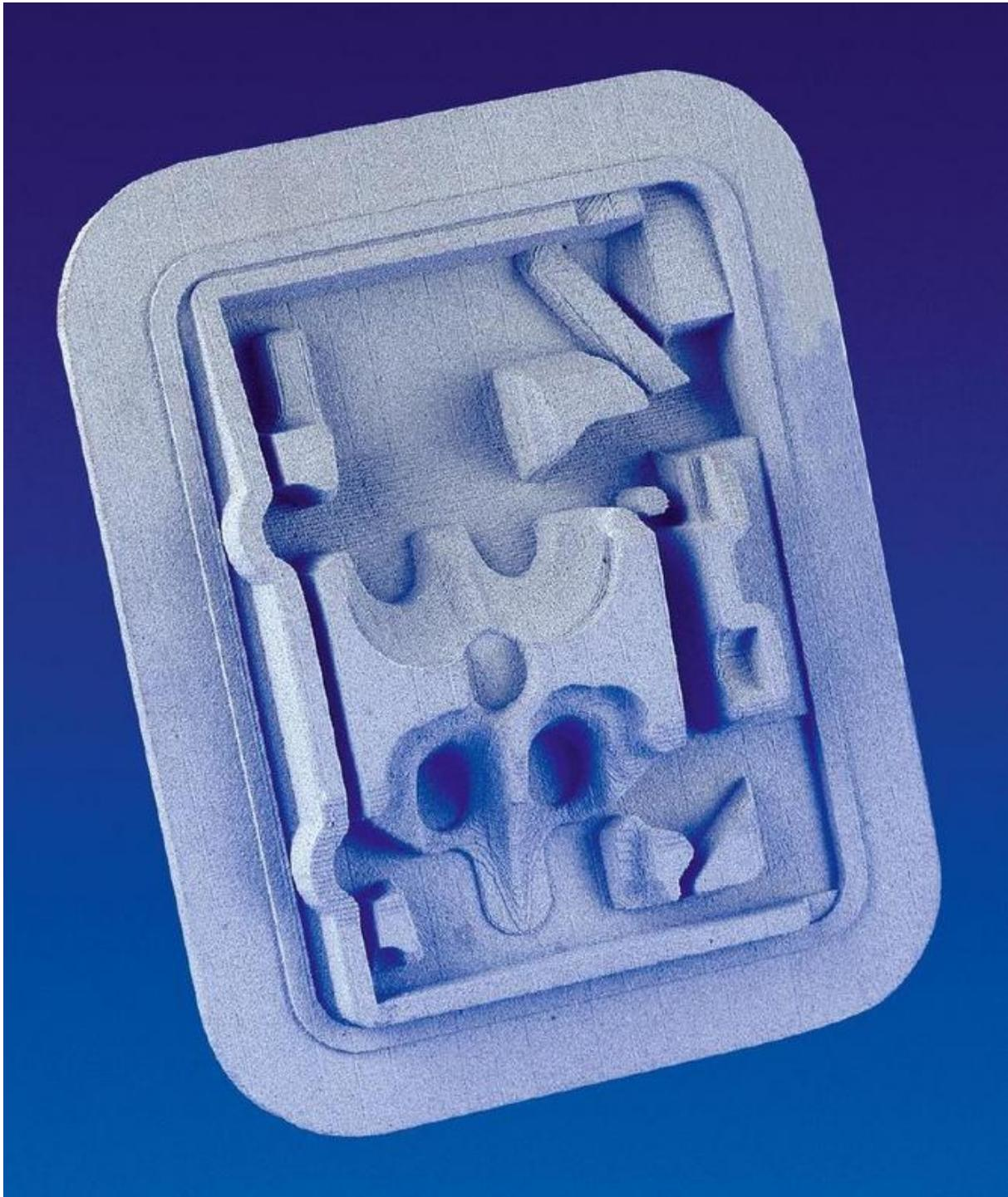
Ein Gehäusedeckel aus dem Metalldrucker. ©Fraunhofer IFAM
