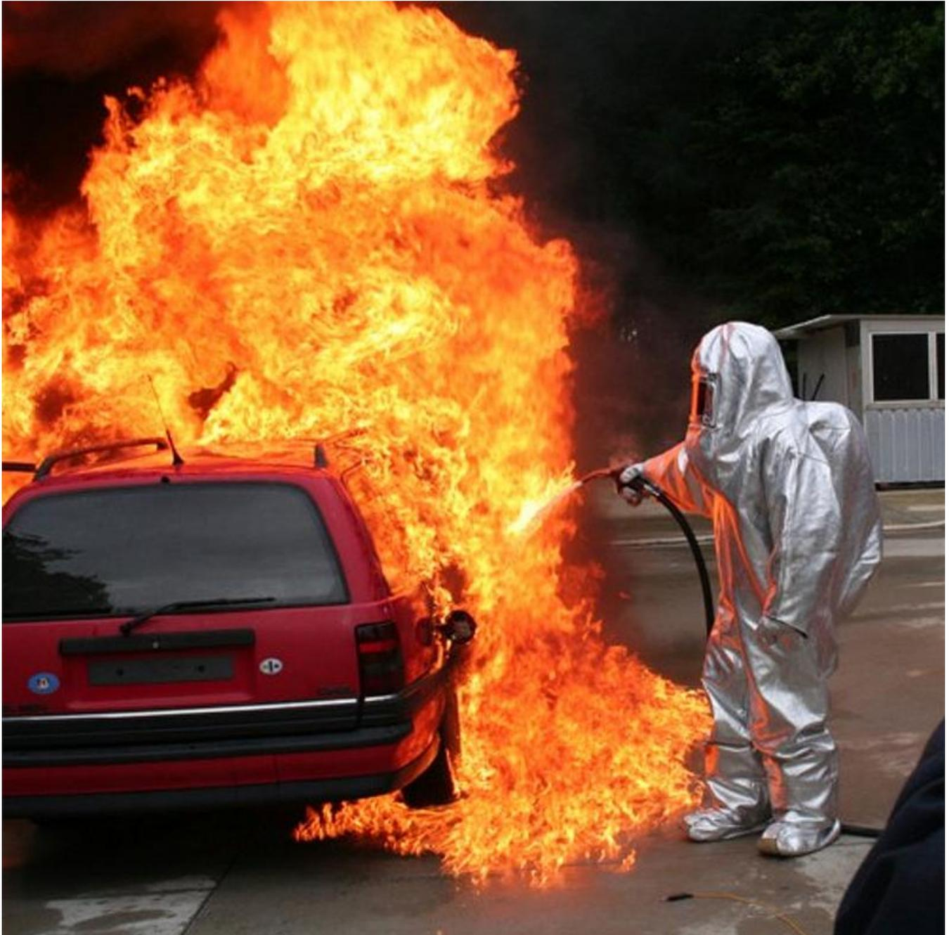
Falsch ist, bei einem Feuer das noch laufende Zapfventil aus dem Tank zu ziehen - der brennende Treibstoff setzt dann die Umgebung in Brand.
