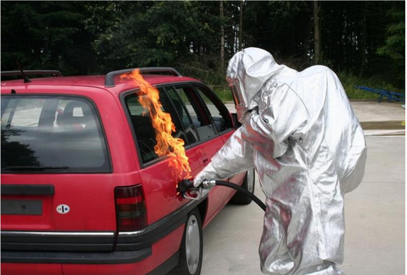
Demonstration eines Brandes, der in seltenen Fällen während des Tankens z.B. durch elektrostatische Entladung entstehen kann: Auf dem ersten Bild ist die Entzündung der Kraftstoffdämpfe am Tankeinfüllstutzen zu sehen.
